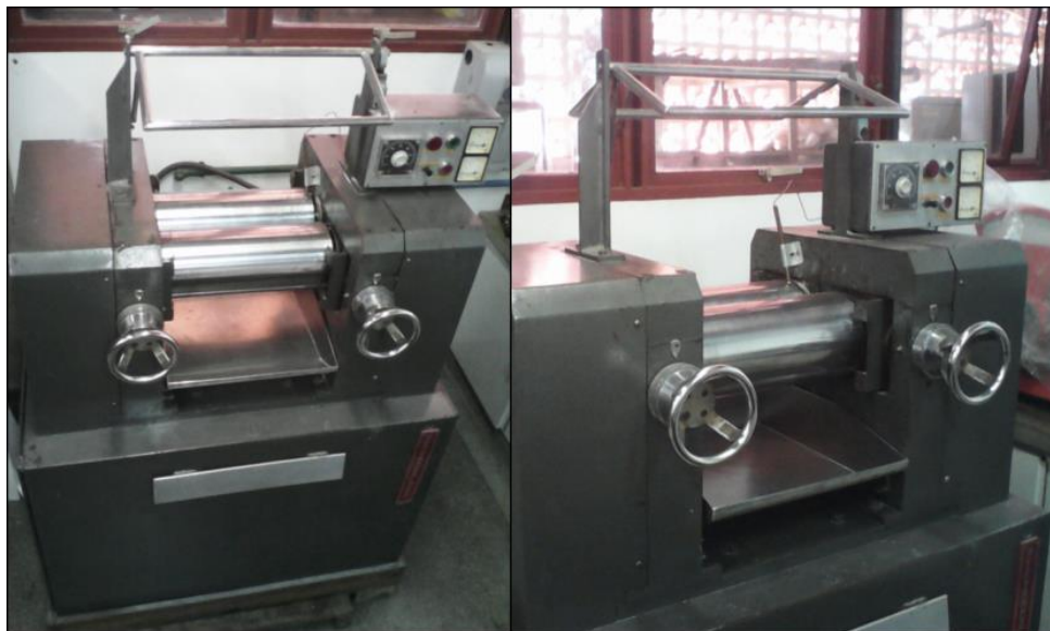
Figura 4.6 Fotos do misturador de rolos realizando os processos de mastigação e homogeneização da mistura entre os compósitos de BN extrudado/desvulcanizado e não vulcanizado acelerado com enxofre. Fonte: Nunes, A. T.
