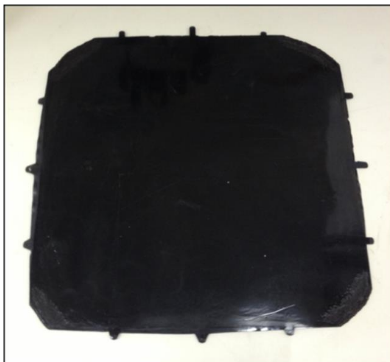
Figura 4.7 Placa de compósitos de BN revulcanizados, partir de material desvulcanizado por extrusão em rosca dupla. Fonte: Nunes, A. T.
