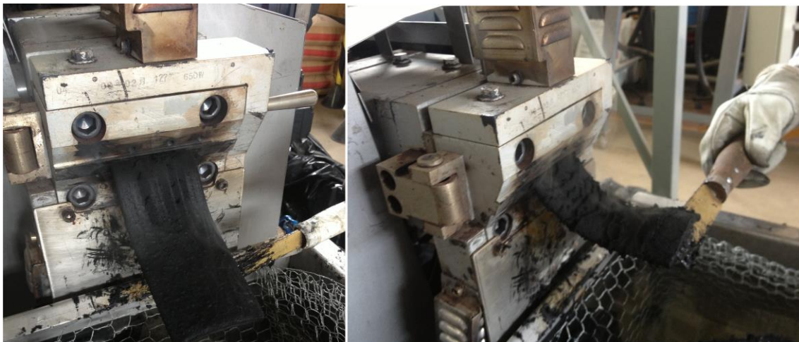
Figura 5.25 Perfil extrudado das amostras de CBN obtido no cabeçote de extrusão. Fonte: Nunes, A. T.
