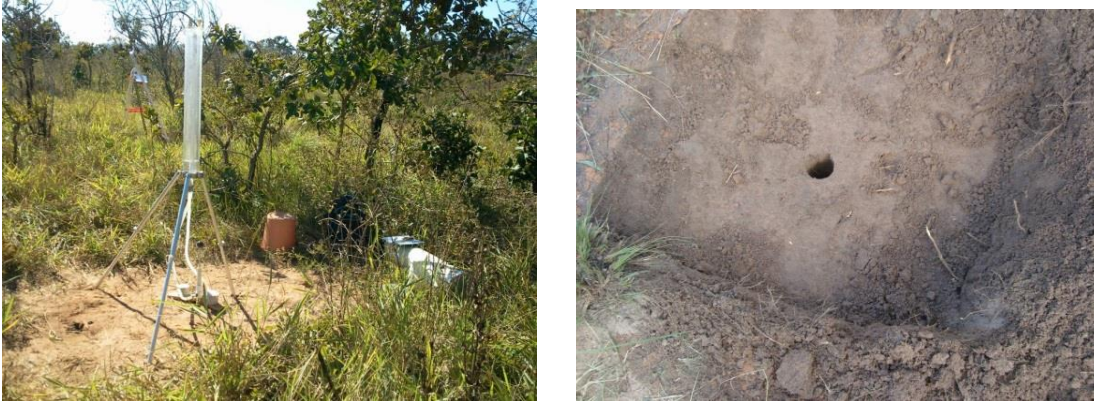
Figura 13 e 14- Permeâmetro Guelph modificado instalado para a realização do ensaio e solo preparado, nivelado e com o furo para o posicionamento do equipamento.
