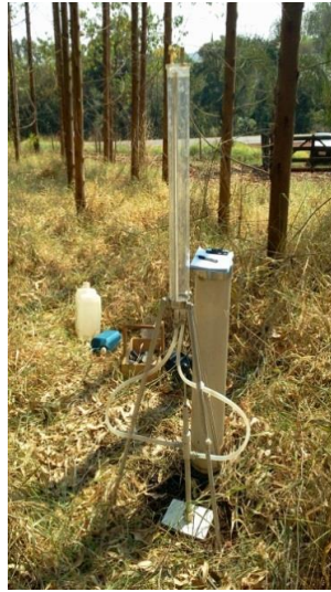
Figura 30 – Local de retirada de amostra do Residual do Serra Geral para caracterização granulométrica e realização de ensaio de penetrômetro de impacto e permeâmetro Guelph.
