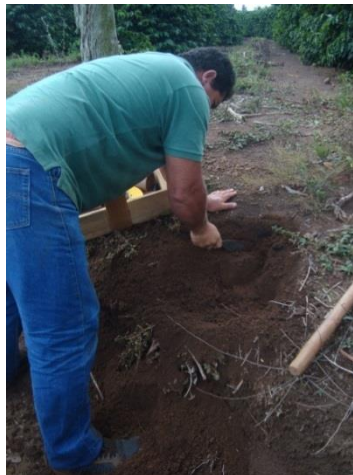
Figura 37- Retirada de amostra indeformada de um material inconsolidado retrabalhado arenoso III.
