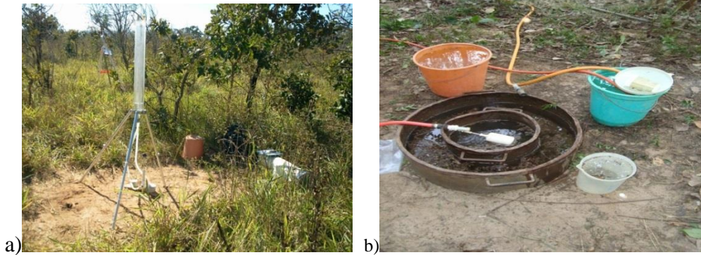
Figura 34 e Figura 35- Ensaios de infiltração utilizando o permeâmetro Guelph (a), o método de duplo anel em duas áreas diferentes do residual do Botucatu.
