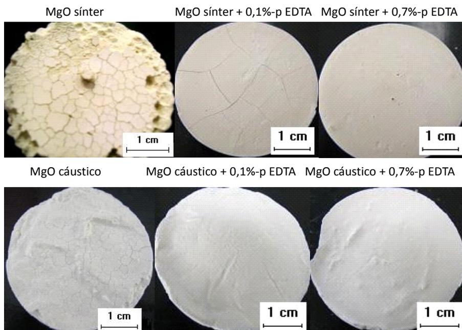
Figura 4.74 Evolução macroestrutural do MgO sínter sem e com adição de EDTA, hidratado durante 7 dias, a 50 °C, umidade relativa de 80% e do MgO cáustico hidratado por 24 h.
