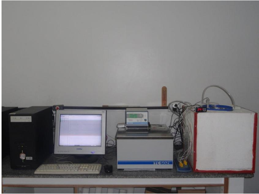
Figura 6A Sistema para medição de calor isotérmico desenvolvido.
