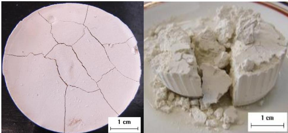
Figura 2.3 Fotos ilustrativas dos efeitos da hidratação da magnésia em suspensão. (Fonte da autora).
