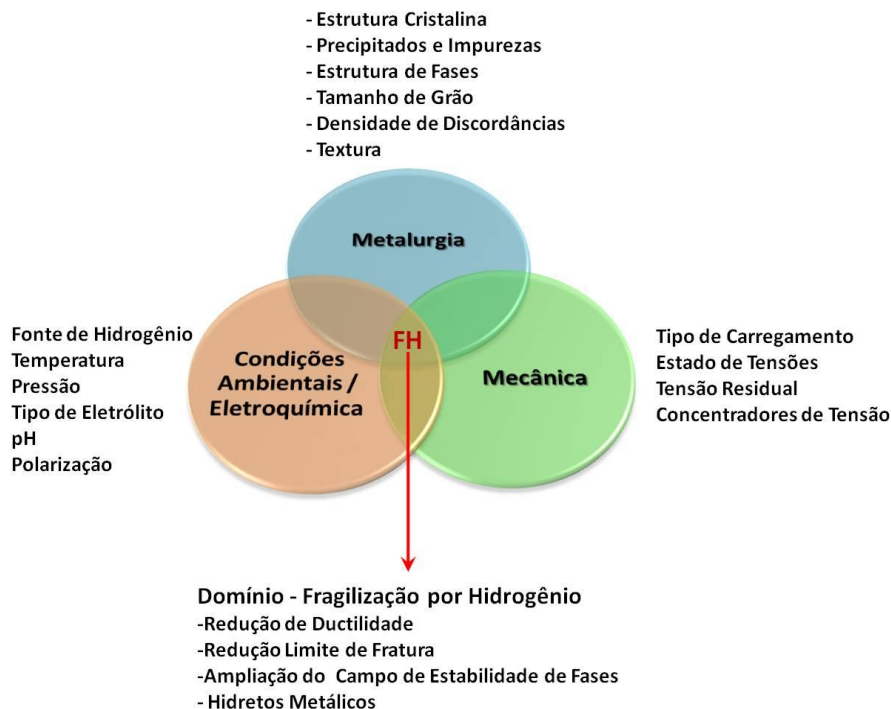
Figura 2.7: Interação de variáveis no processo de fragilização por hidrogênio.
