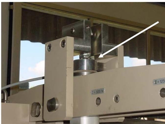
Figura 0.5 Em destaque a célula de carga, com capacidade de 5000 N, do equipamento do módulo de ruptura a quente, HBST.
