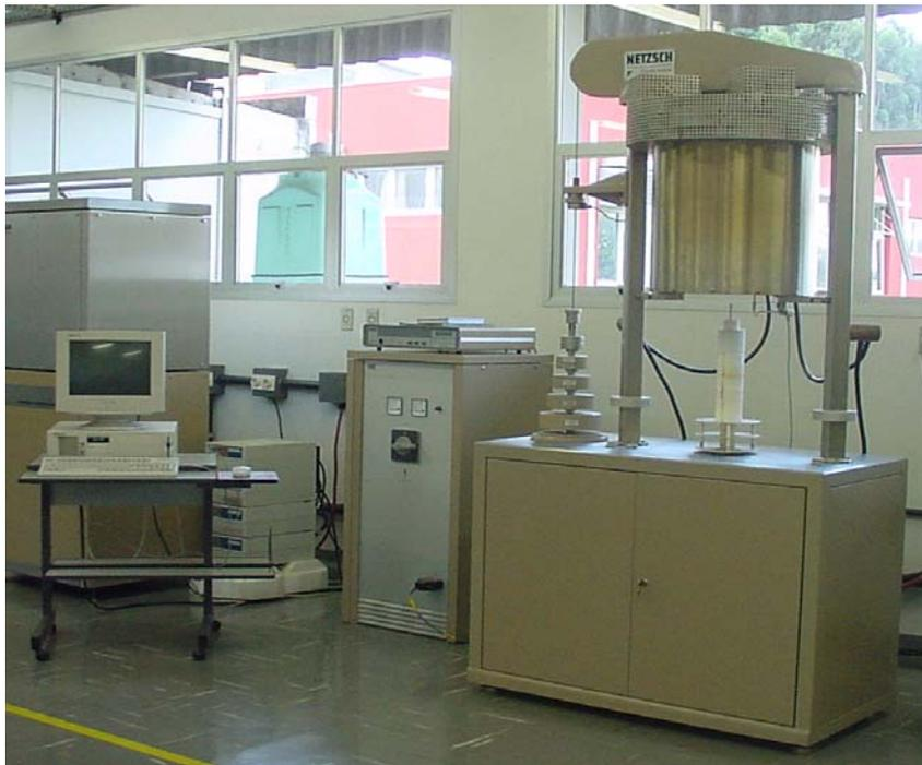
Figura 4.5 Foto do equipamento de refratariedade-sob-carga, modelo RUL 421E, da Netzsch.
