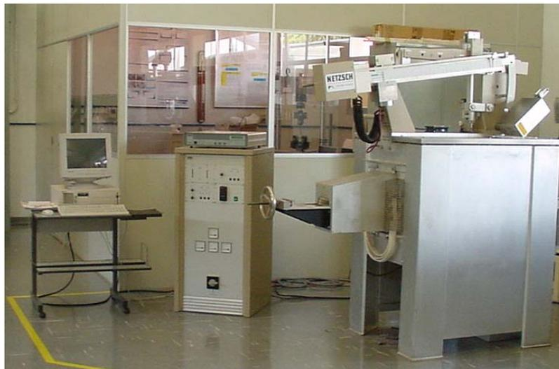
Figura 4.4 Foto do equipamento de módulo de ruptura a quente, modelo HBST 422, da Netzsch.
