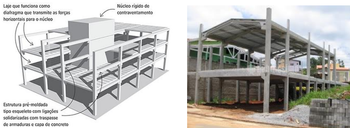
Figura 16 – Elementos pré-fabricados de concreto
