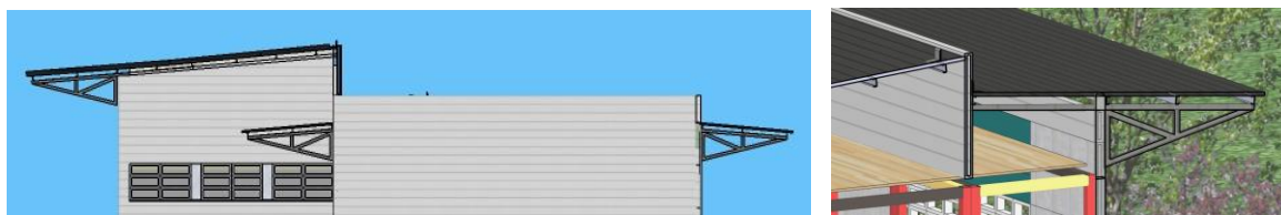
Figura 62 – Beiral da cobertura
