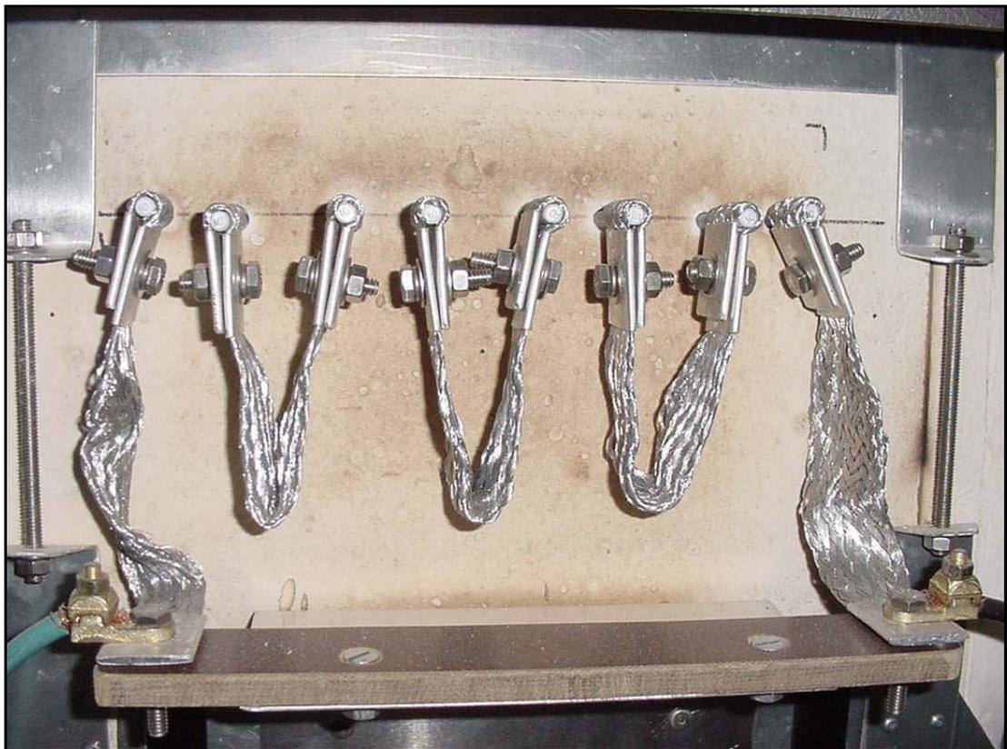
Figura 4.9 - Esquema de interligação das resistências elétricas.
