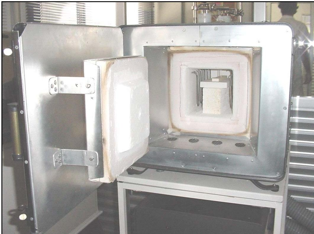
Figura 4.7 - Forno elétrico para realização dos ensaios a altas temperaturas.
