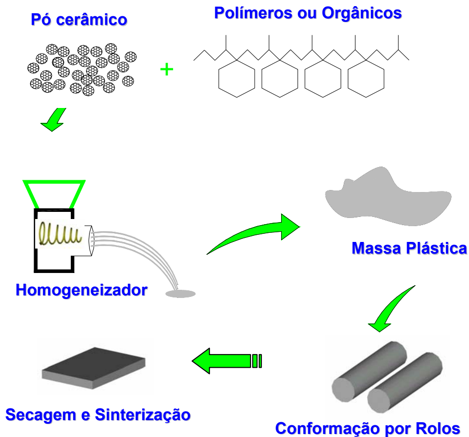
Figura 2.3 Etapas de processamento de uma massa plástica (Processamento Visco-Plástico) [4].
