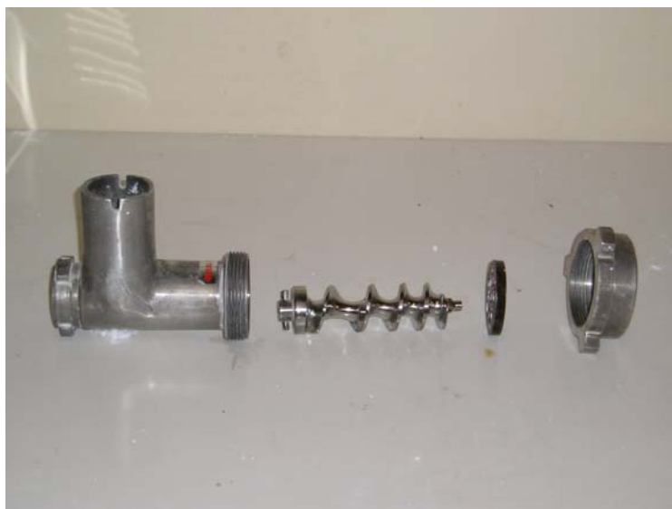
Figura 3.2 Detalhe dos componentes do moinho de facas (extrusora).
