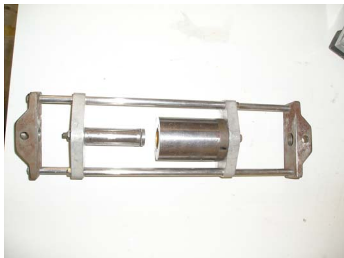
Figura 3.8 Dispositivo de avaliação do comportamento reológico de massas plásticas.
