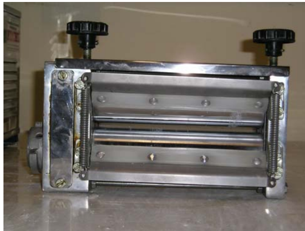
Figura 3.3 Calandra utilizada para a laminação a frio.
