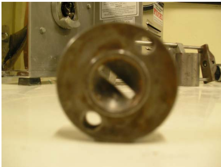
Figura 3.9 Bocal utilizado para a determinação do comportamento reológico das massas plásticas.
