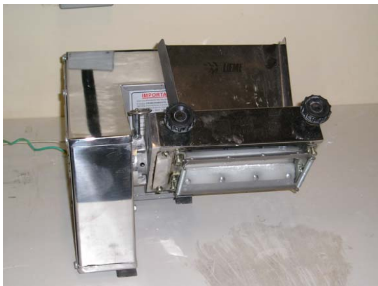
Figura 3.4 Calandra utilizada para laminação a frio acoplada à fonte de energia.
