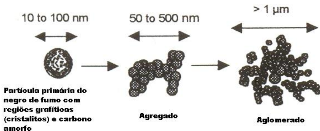
Figura 3.32 Partículas primárias do negro de fumo fundidas no reator, e sua forma em agregado e aglomerado. [34]
