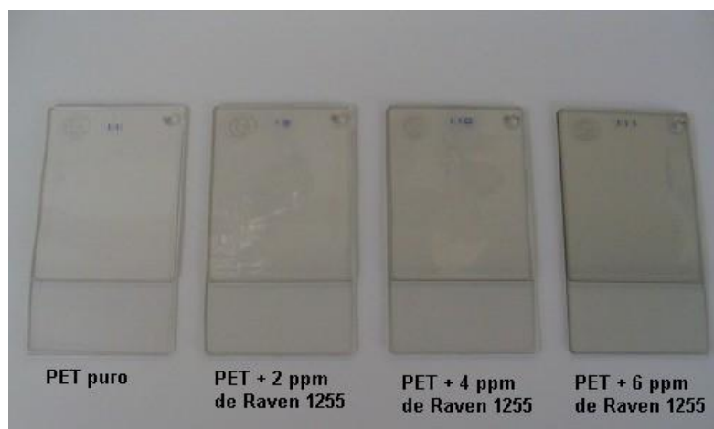
Figura 4.5 Composição de resina PET com o negro de fumo Raven 1255.
