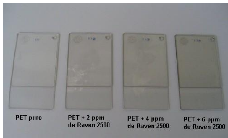
Figura 4.6 Composição de resina PET com o negro de fumo Raven 2500.
