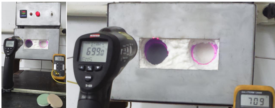
Figura 3.5 Dispositivo de medição indireta de emissividade.
