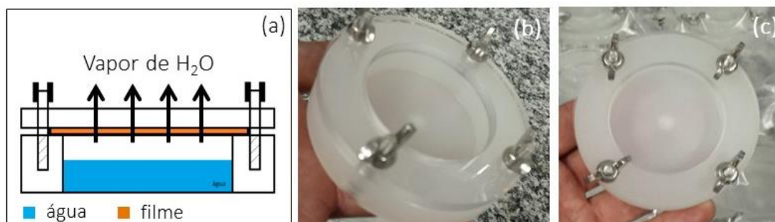
FIGURA 4. 2: Célula para análise da permeabilidade ao vapor de água segundo método modificado por MCHUGH et al. (1993): (a) esquema da célula com o filme; (b) e (c) imagens das células reais utilizadas.
