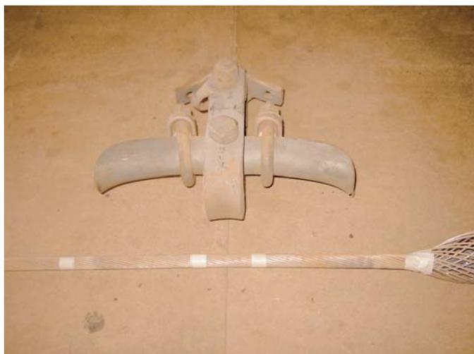
**Figura 4.1:** Região de grampeamento e grampo para o condutor Oriole.
