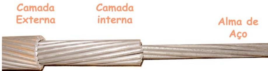
**Figura 2.3:** Formação do Cabo condutor CAA - 30 fios de alumínio (Coroa com duas camadas) e 7 fios de aço (Alma).
