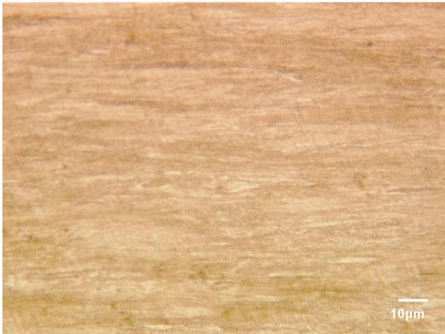
**Figura 4.19:** Microestrutura alongada do aço da alma do condutor novo. Seção longitudinal do fio.
