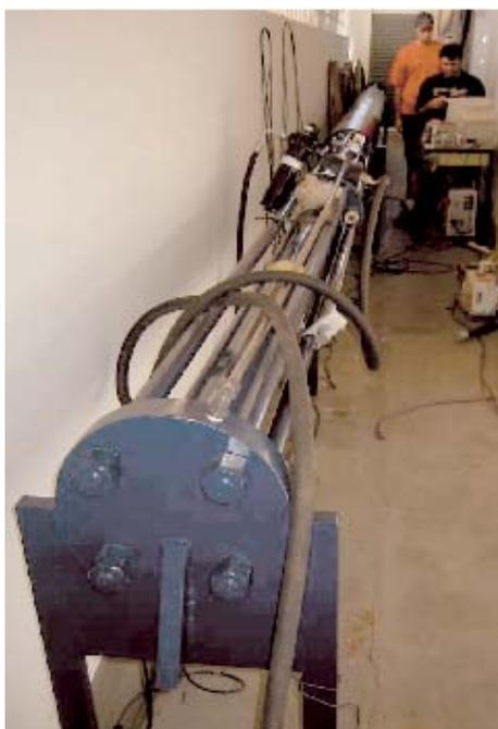
**Figura 3.5:** Máquina de ensaio de tração com sistema de aquisição de dados
