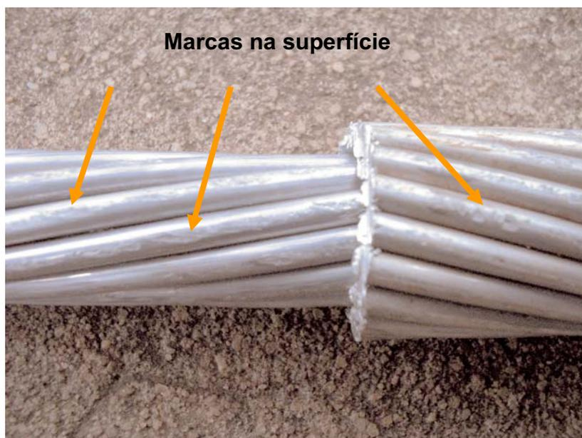
**Figura 4.20:** Marcas na superfície do condutor Oriole.
