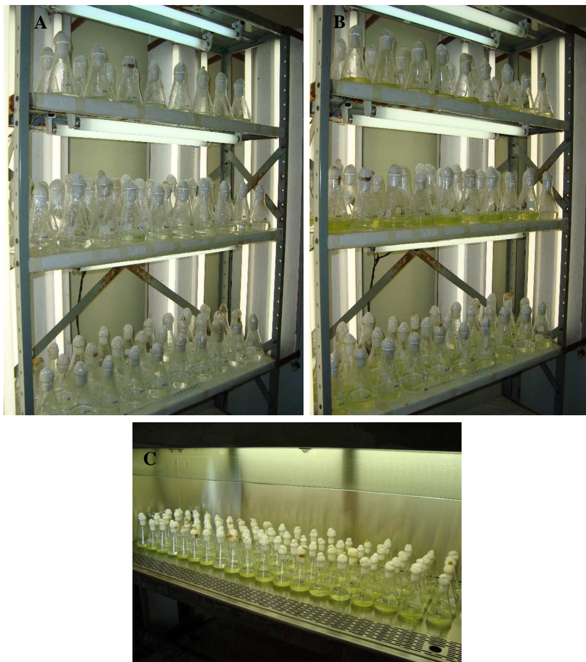
Figura 11. Vista geral do teste de toxicidade de mistura utilizando a alga Raphidocelis subcapitata como organismo-teste. A) Frascos-teste no início do experimento; B) Frascos-teste após 96 horas de exposição às misturas dos compostos; C) Frascos-teste dentro da câmara de fluxo laminar para retirada de sub-amostras (Fotos: Adrislaine S. Mansano, 2016).
