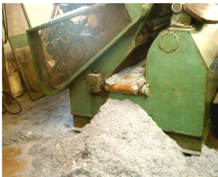
Figura 3.5 Saída lateral da rebaixadeira: formação da raspa de couro.
