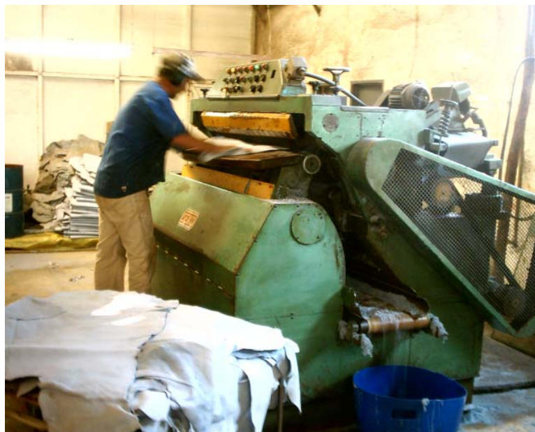
Figura 3.4 Regularização da espessura do couro na rebaixadeira.
