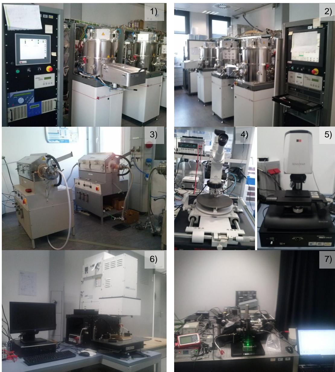
Figura 4: Equipamentos utilizados 1) Sistema de sputtering dos precursores metálicos (Cu, Zn, Sn) e Mo; 2) Sistema de sputtering de óxidos; 3) Fornos tubulares com atmosfera controlada utilizado para o tratamento térmico e a selenização, 4) Serra de diamante para produzir as raias nas células; 5) Microscópio multifocal utilizada para as medidas de perfilometria óptica digital, 6) Simulador solar e 7) Micro-Raman.
