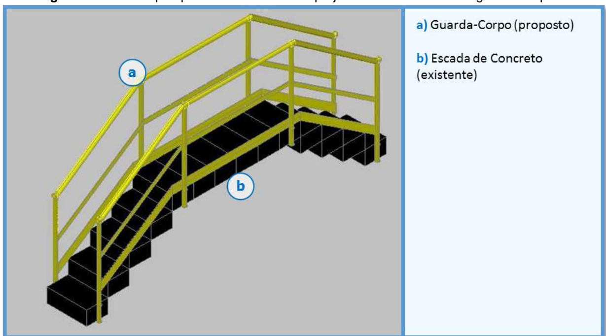
Figura 14 Vista em perspectiva do CAD 3D de projeto conceitual inicial de guarda-corpos
