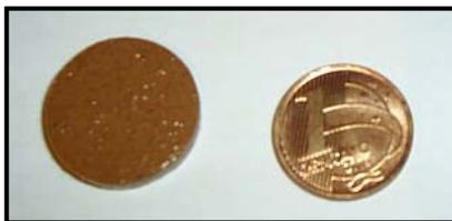
Figura 4.23 Vitrocera de LAS SnO<sub>2</sub> preparada a partir de vidros moídos por 200 minutos e sinterizada a 1100°C (taxa de 30°C/min).
