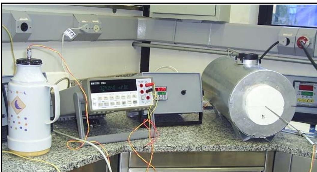
Figura 3.10 Forno elétrico laboratorial para processamento das vitrocerâmicas de LAS conectado a um microcomputador com software para a aquisição de dados em tempo real.
