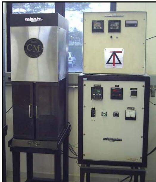
Figura 3.2 Forno de Fusão botton load marca CM – Bloomfield N. J.
