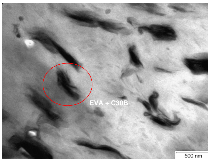
Figura 4.44 Micrografia de MET do grânulo do nanocompósito de PEAD/EVA 25/C30B (80/15/5), com aumento de 31000x.
