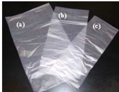
Figura 4.17 Filmes de PEAD (50 \mu m de espessura) obtidos em diferentes condições de processamento: (a) 70 rpm / BUR = 1,6 / TUR = 11; (b) 80 rpm / BUR = 1,2 / TUR = 14,5; (c) 65 rpm / BUR = 1,0 / TUR = 18,5.
