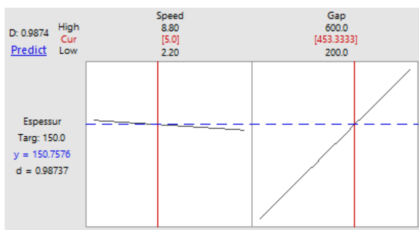
Figura 36 - Simulação matemática da espessura das fitas coladas em função dos parâmetros do DOE
