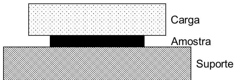
Figura 24 - Esquema do uso de peças cerâmicas como carga de sinterização
