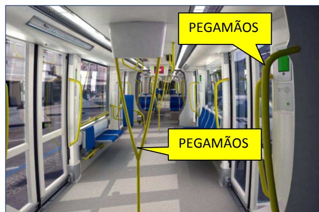
Figura 20 - Sistema de pegamãos no salão de passageiros Fonte: CCR (2013)
