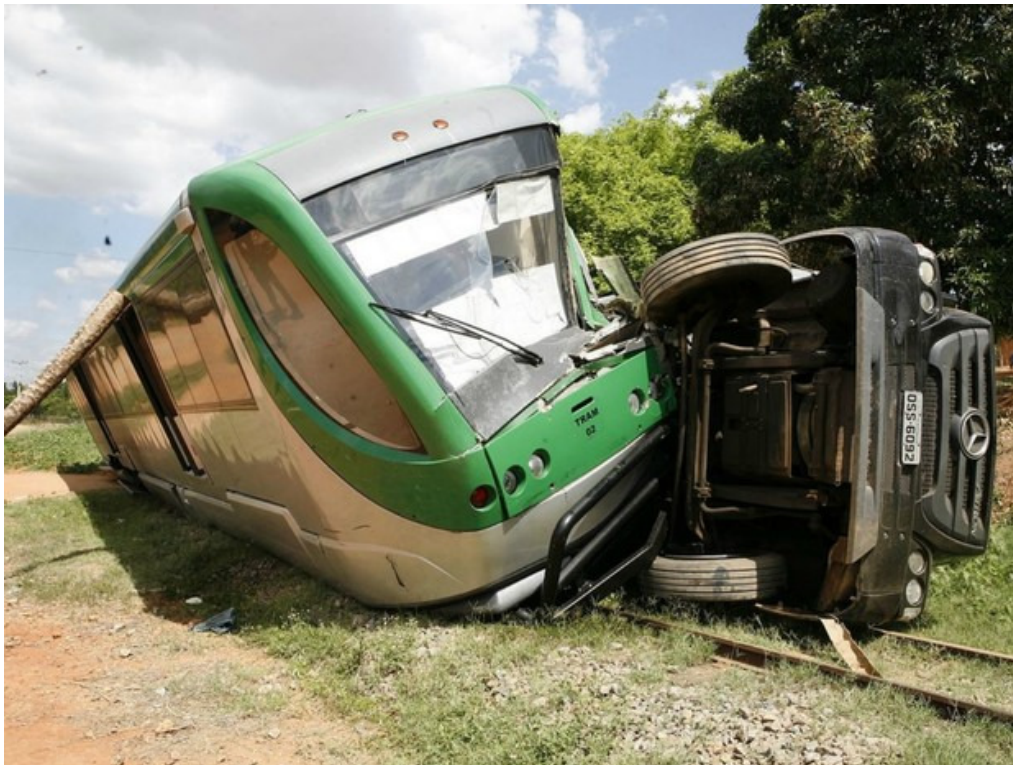
Figura 47 - Acidente envolvendo o VLT provocado pela invasão da via por um caminhão Fonte: Engenharia ferroviária (2014)
