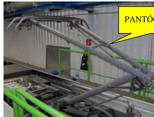
Figura 24 - Detalhe de um pantógrafo Fonte: Maunsell/DPI (2007)
