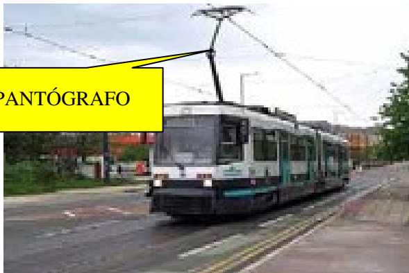
Figura 23 - Captação de energia via pantógrafo Fonte: Maunsell/DPI (2007)
