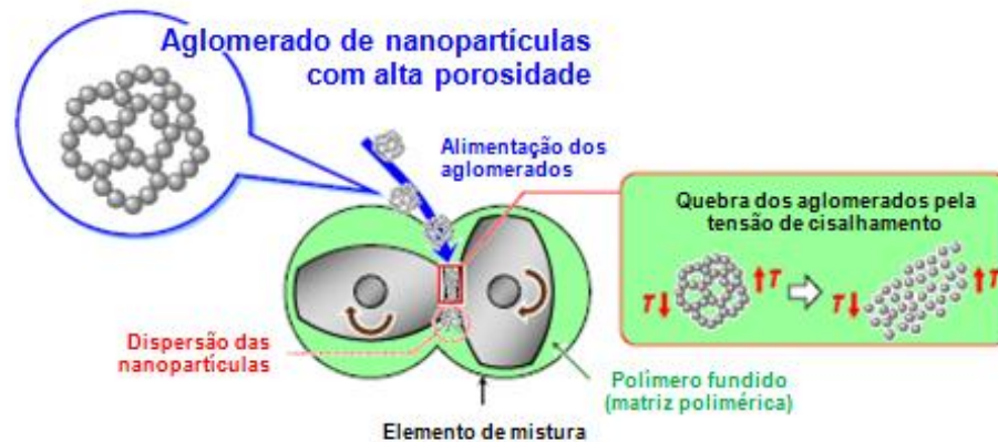
Figura 2.7 Ilustração do processo compostagem no estado fundido de nanocompósitos poliméricos. Detalhe para importância da porosidade dos aglomerados no processo de dispersão das cargas na matriz [24].
