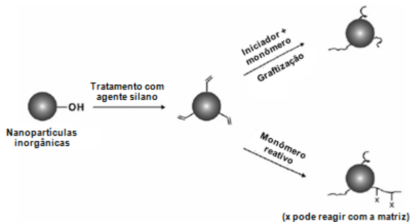
Figura 2.5 Representação esquemática da enxertia utilizando duplas ligações nas partículas [22].
