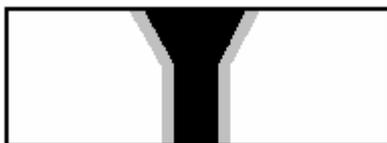
Figura 3.1 Esquema ilustrativo de uma junta soldada por FE-BV: MB (região clara), ZTA (região cinza) e MS (região escura).
