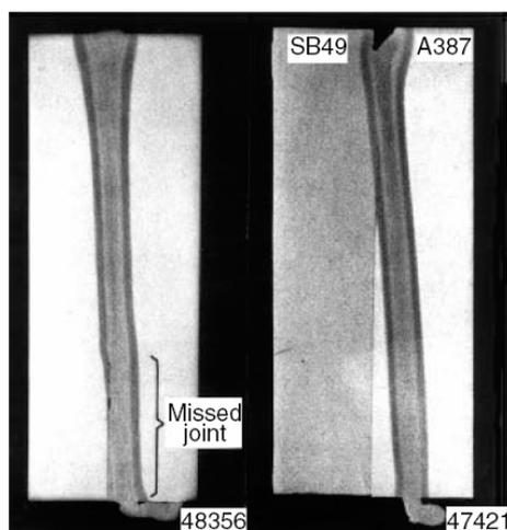
Figura 2.10 Desalinhamento provocado pelo magnetismo do material a ser soldado [1].
