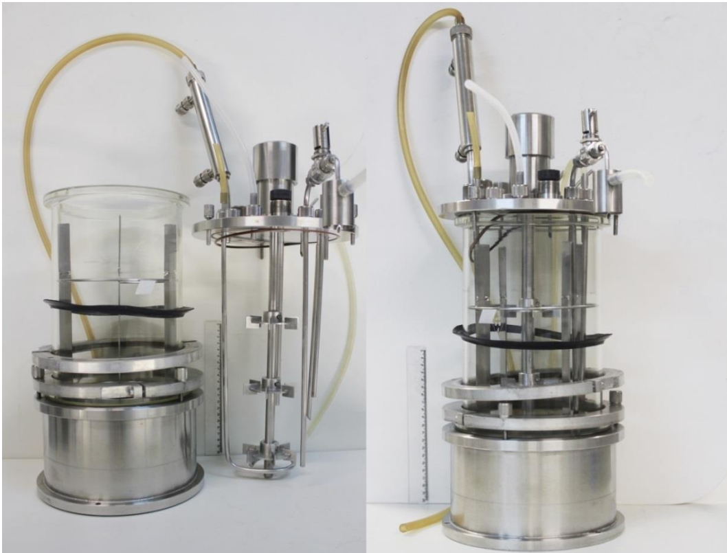
Figura 3.1. - Biorreator de bancada exibindo aspectos exteriores e interiores (Escala: régua 20cm).
