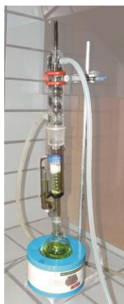
FIGURA 4.79 - Montagem para extração soxhlet semelhante à que foi utilizada no estudo de comparação com os métodos farmacopeicos. A diferença foi a acomodação do material vegetal em um cartucho de papel filtro
