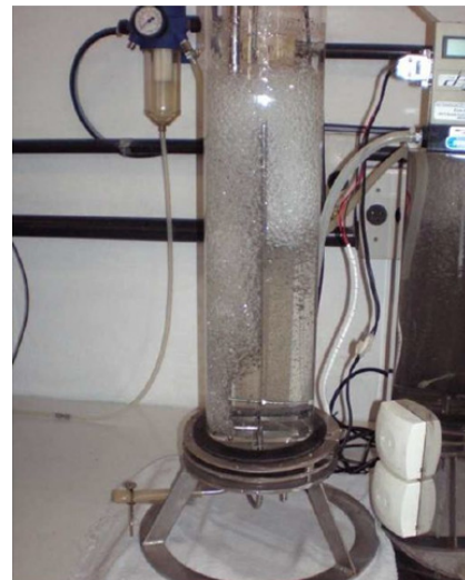
Figura 3.3 – Biorreatores operando em laboratório: a) tanque agitado e aerado; b) airlift split
