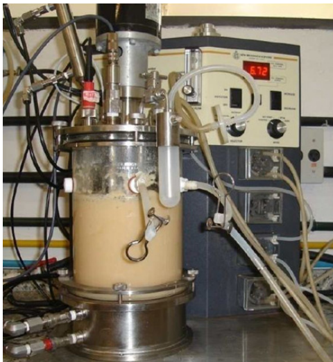
Figura 3.3 – Biorreatores operando em laboratório: a) tanque agitado e aerado; b) airlift split
