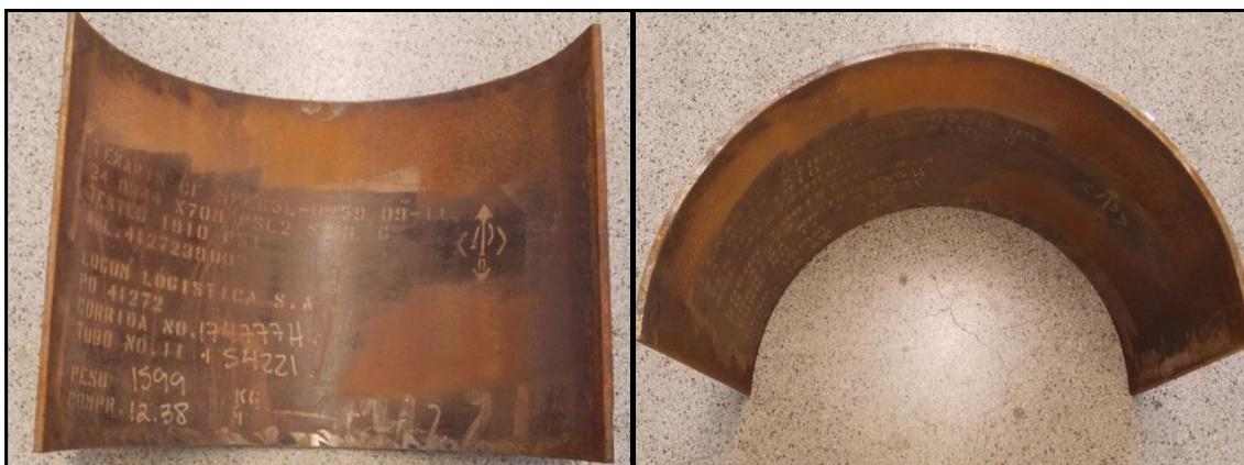
FIGURA 3.1 - Foto da amostra do tubo API 5L\_X65.
