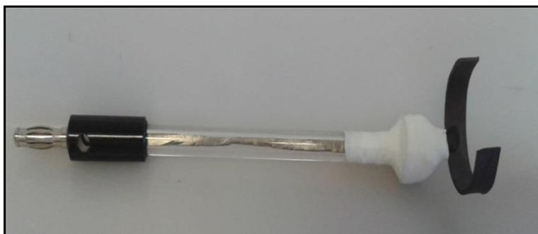
FIGURA 3.3 - Eletrodo auxiliar de Pt preparado pelo método de Pechini.
