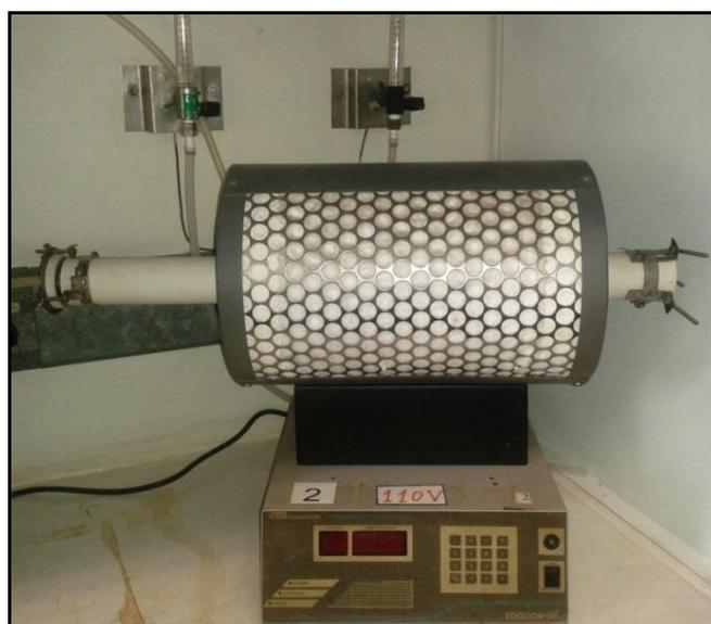
FIGURA 3.5 - Forno tubular utilizado para tratamento térmico da amostra a uma temperatura de 900 °C.
