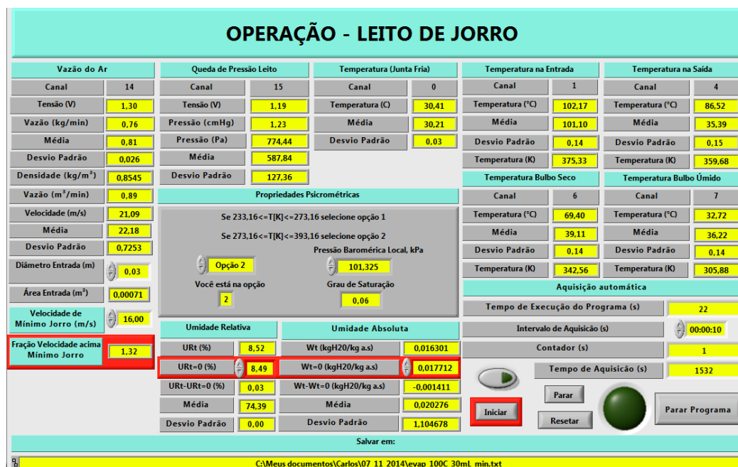
Figura 3. 6 - Painel de monitoramento de variáveis desenvolvido a partir do software LabVIEW 6.1 para os ensaios de secagem no leito de jorro.
