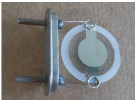
Figura 3.2 - Representação de um cristal de quartzo recoberto com platina.
