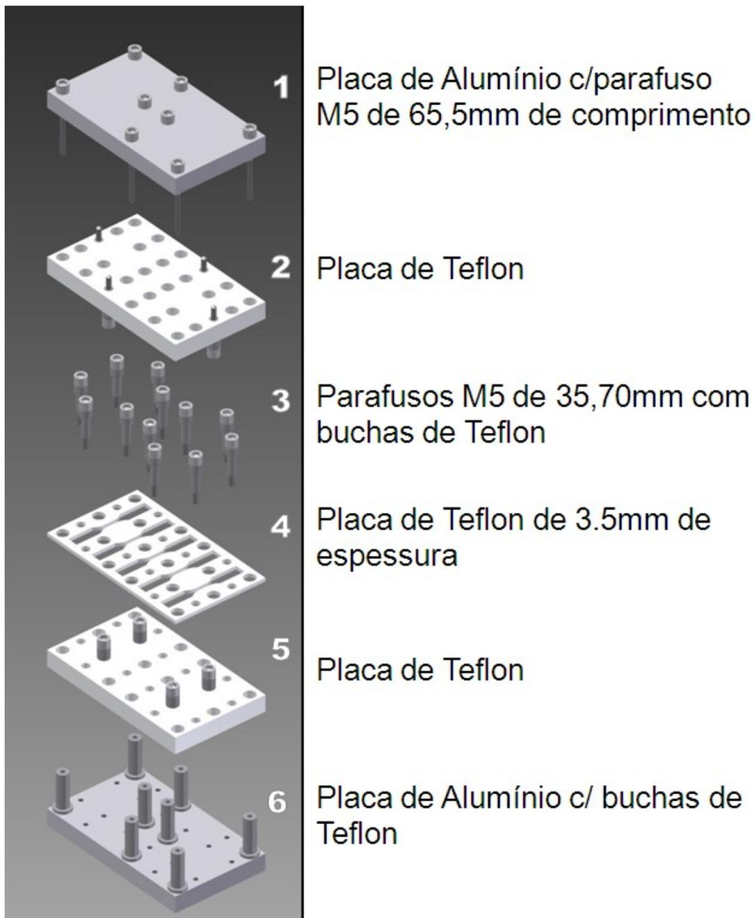
Figura 3.4 - Molde de Teflon construído para obtenção de corpos de prova em acordo com a medida ASTM D638 tipo V. Fonte: Elaborada pelo autor.
