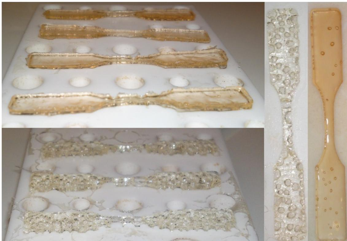
Figura 4.14 - Corpos de prova dos polímeros Observam-se corpos de prova dos polímeros de glicerol com ácido cítrico (transparente) e anidrido ftálico (amarelo) respectivamente, mostrando a presença de bolhas e irregularidades nos corpos de prova obtidos. Fonte: Elaborada pelo Autor.
