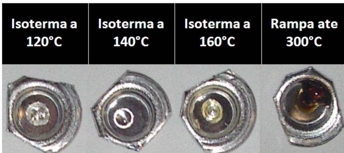
Figura 4.8 - Fotografias das panelas utilizadas apos análise TG da mistura de ácido cítrico com glicerol. Fonte: Elaborada pelo Autor.
