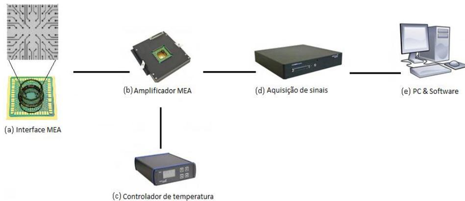
**Figura 1.1 – Configuração básica do sistema MEA.**
