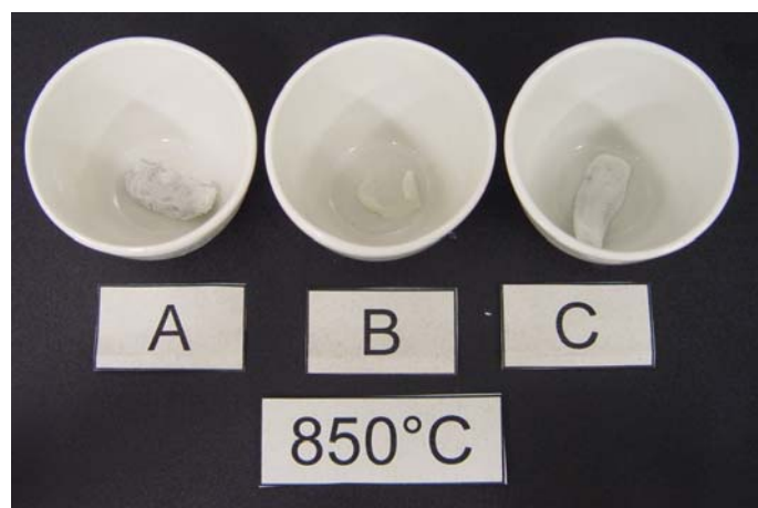
Figura 25 – Amostras de corpos de prova de flexão calcinados a 850°C: amostras A, B e C.
