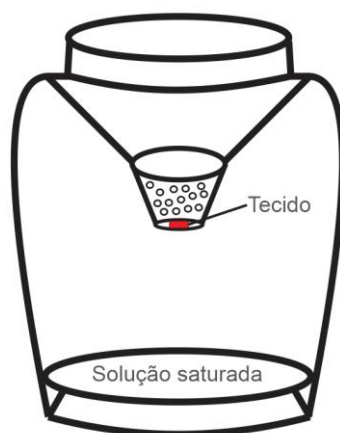
Figura 3. 7- Esquema do aparato experimental utilizado na obtenção de isotermas.
