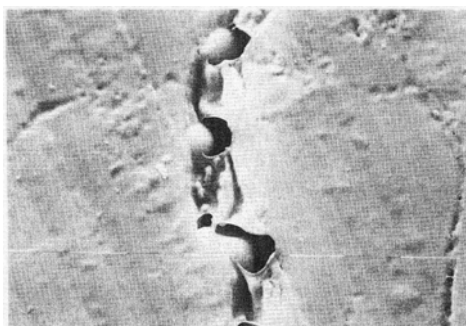
Figura 2.6 Micrografia de um filme fraturado de PHB carregado com amido (fator de aumento x1500) [32].
