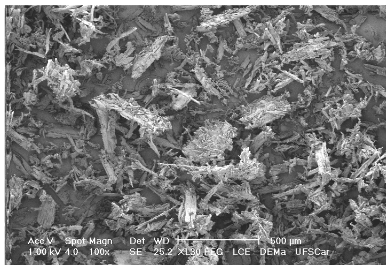
Figura 4.2 Micrografia do pó de madeira - aumento nominal de 100X.
