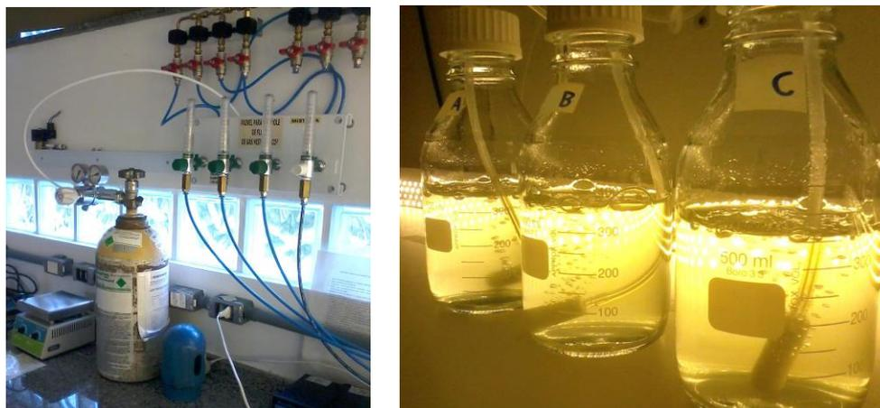
Figura 2. (a) Cilindro utilizado no armazenamento da simulação de gases de combustão (SGC). A ele foi acoplado um regulador de pressão de duplo estágio. Regulada a pressão, o gás era conduzido ao sistema de regulação de fluxo, de onde seguia para as culturas de microalgas. (b) Cultivo de *C. sorokiniana* em frascos de vidro de 500 mL. O borbulhamento de gases foi simultâneo em todas as três réplicas.
