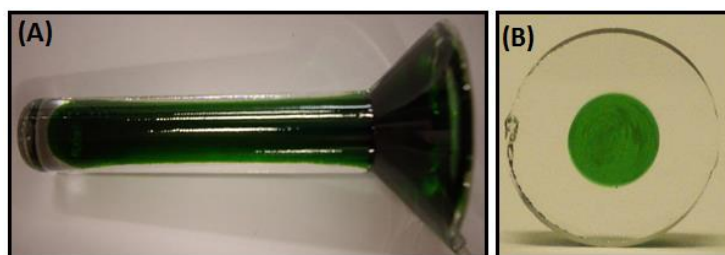
FIGURA 7.1 - Fotografias: (A) Pré-forma do tipo núcleo-casca para a amostra S4G6 e (B) Fatia da pré-forma do tipo núcleo-casca.
