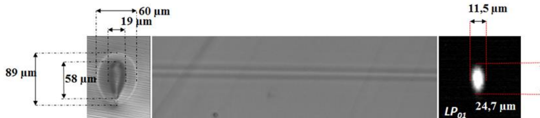
FIGURA 5.36 - Seção transversal, vista superior e perfil modal no campo distante para o guia de onda de onda WG1.
