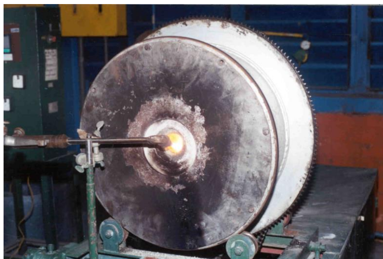
Figura 5.1 Montagem do Forno Rotativo para Ensaio de Molhamento da Escória Dopada com MgO.
