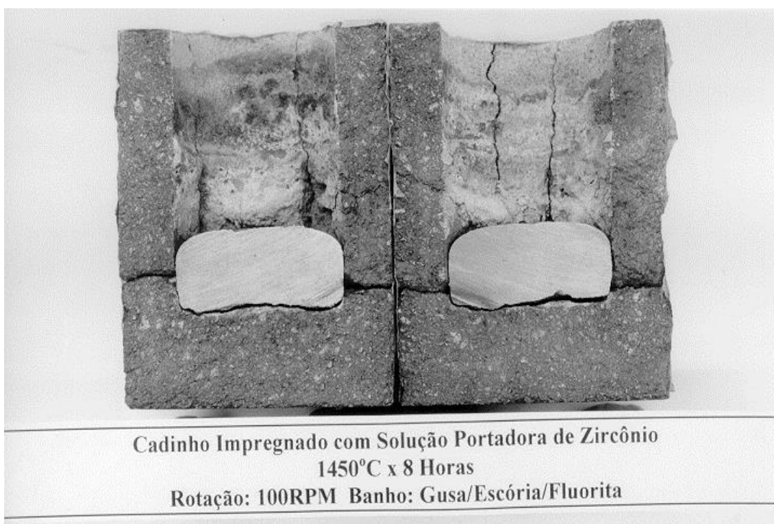
Figura 4.6 Aspecto da Seção Longitudinal dos Cadinho Impregnado com Zircônio.
