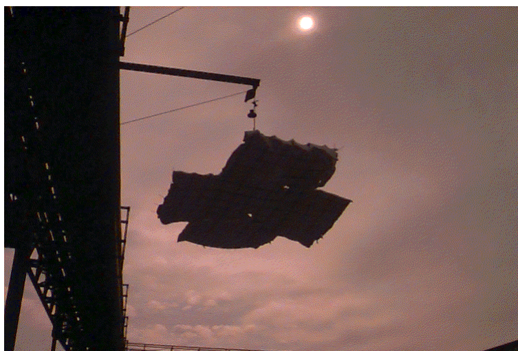
Figura 6.3 Sistema de Colocação e Retirada das Tampas dos Carros Torpedos.
