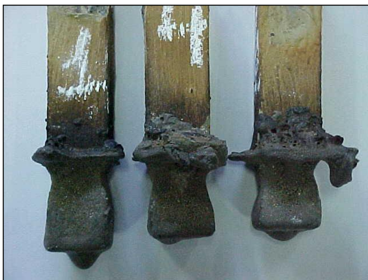
Figura 7.6 ASCM – Convencional x F#1 – PF x F#1 – PQ. Aspecto dos CP's da Formulação #1 Prensada à Frio e à Quente Após Ensaio de Finger Test.
