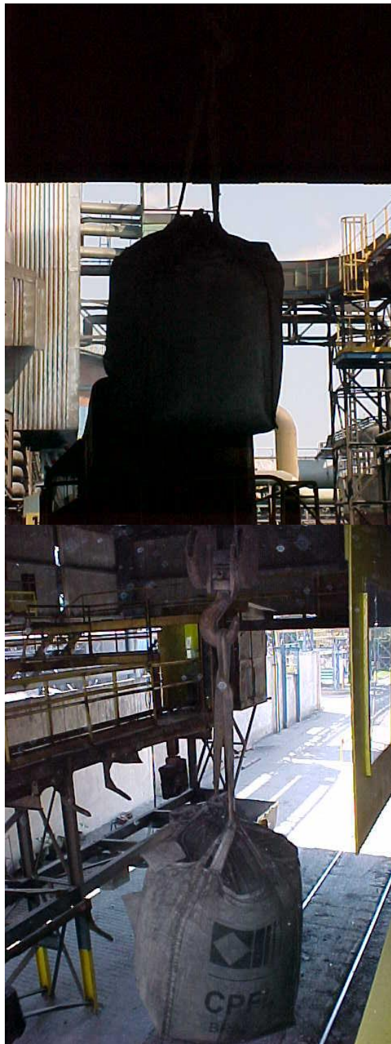
Figura 6.20 Suspensão do Bag Contendo Sucata Refratária de MgO.
