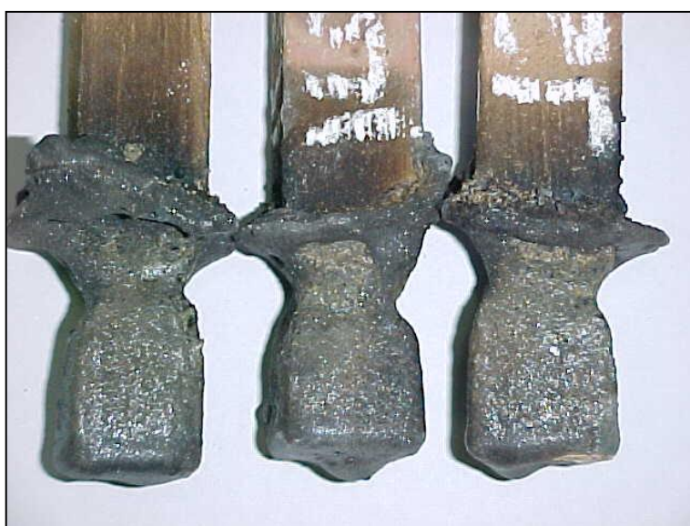
Figura 7.7 ASCM – Convencional x F#2 – PF x F#2 – PQ. Aspecto dos CP's da Formulação #2 Prensada à Frio e à Quente Após Ensaio de Finger Test.
