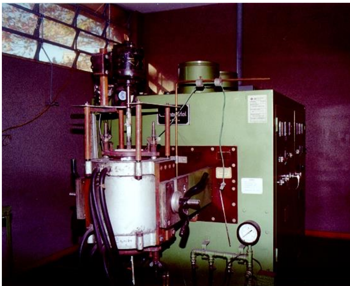
Figura 4.1 Montagem do Ensaio de Escorificação Dinâmica em Forno Tammann.
