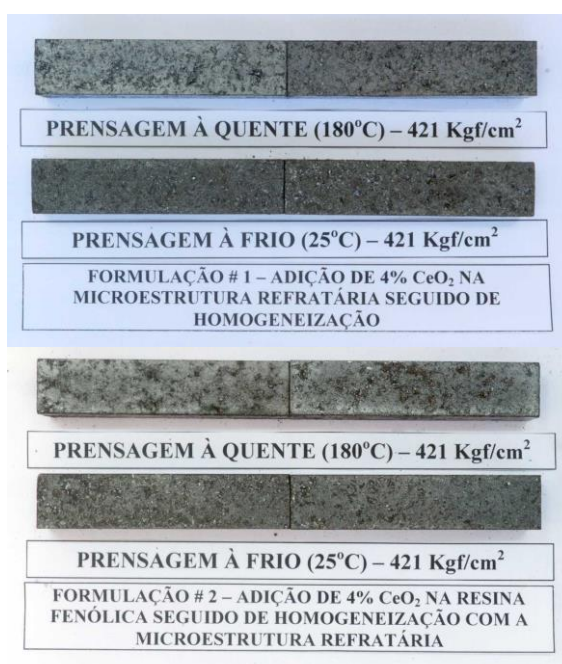
Figura 7.1 Aspecto dos CP's das Formulações #1 e #2 Prensadas à Frio e à Quente.
