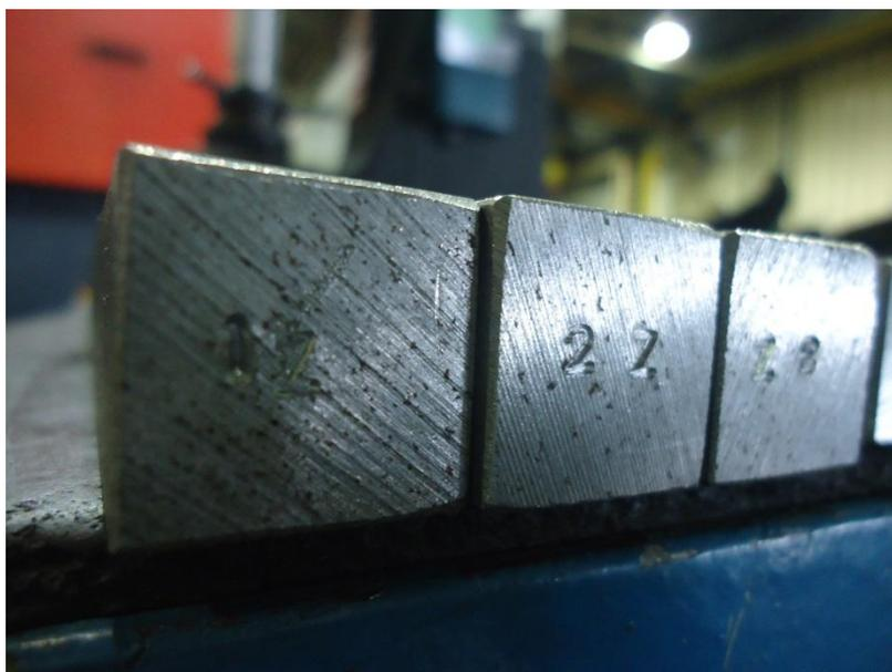
Figura 21 Corpo de prova retirado da barra laminada.
