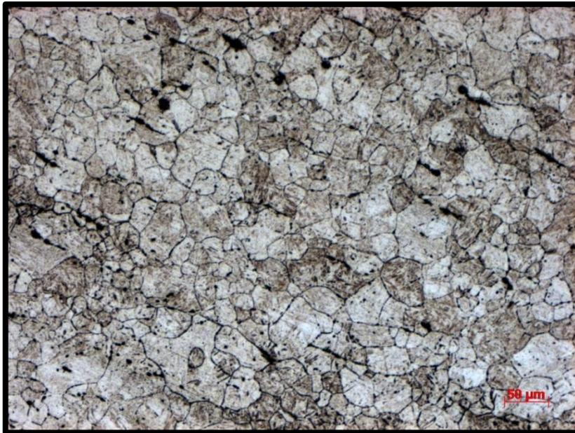
Figura 32 Micrografia da amostra tratada com 100 minutos. Aumento de 100x.
