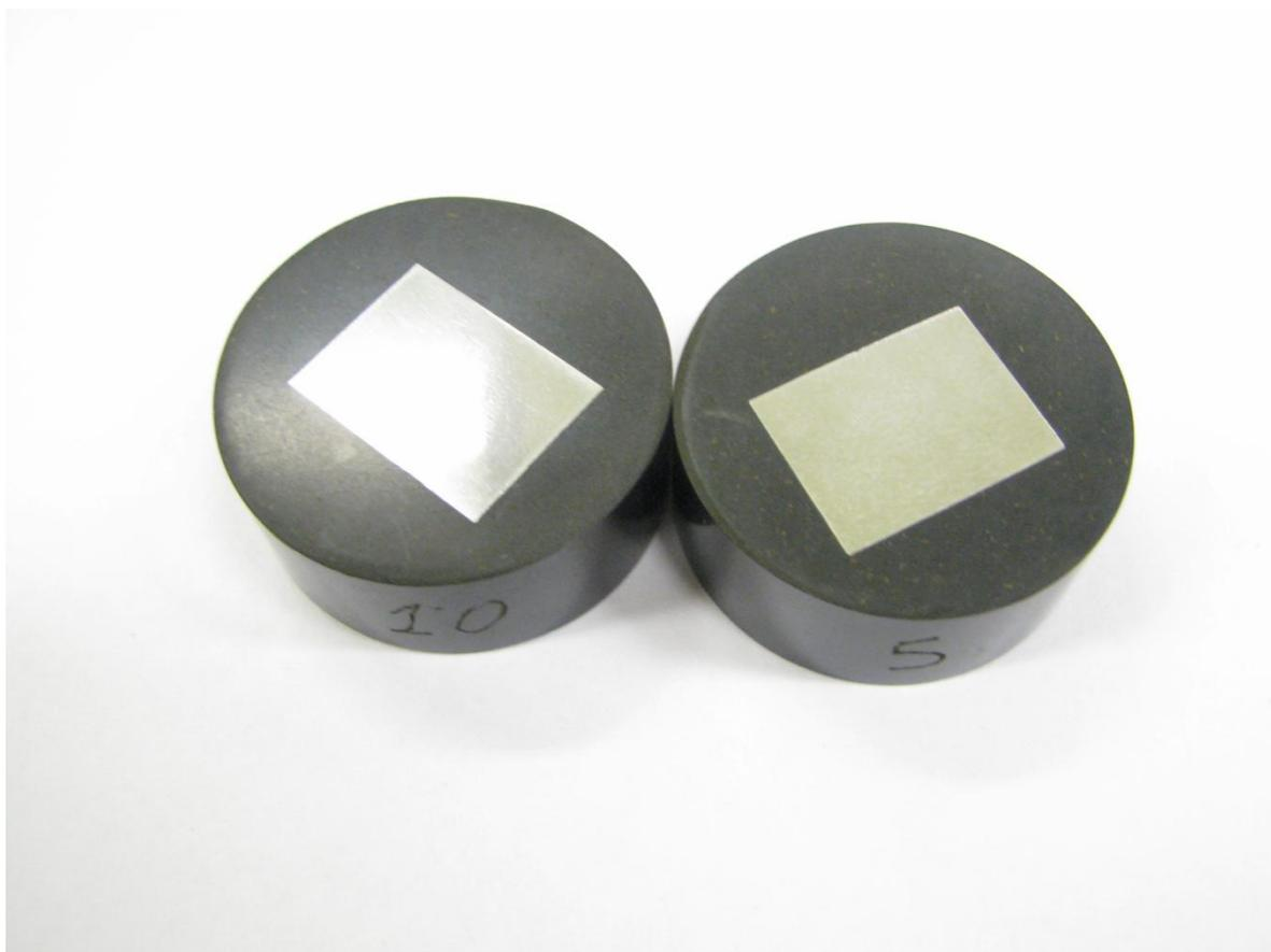
Figura 26 Corpos de prova embutidos em baquelite.
