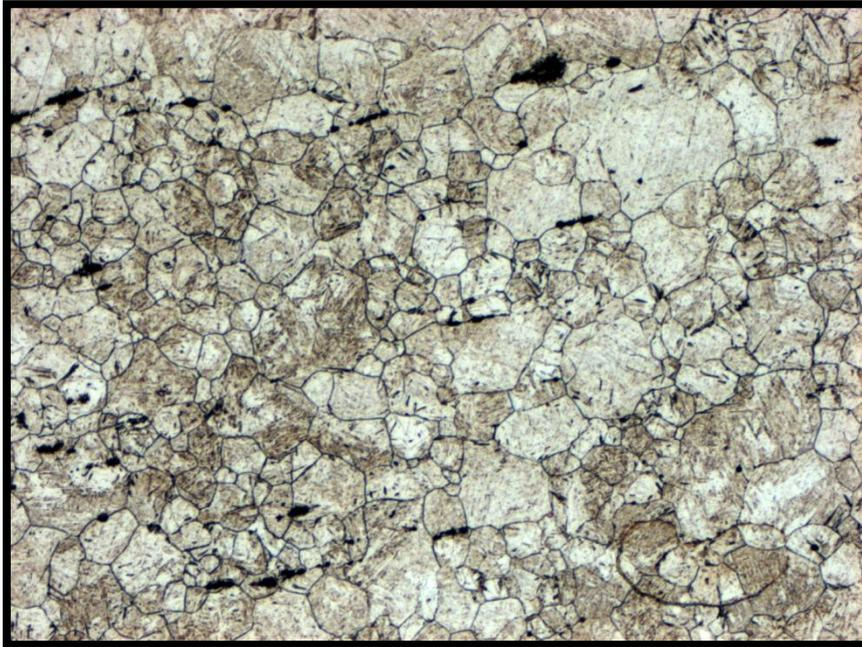
Figura 34 Micrografia da amostra tratada com 240 minutos. Aumento de 100x.
