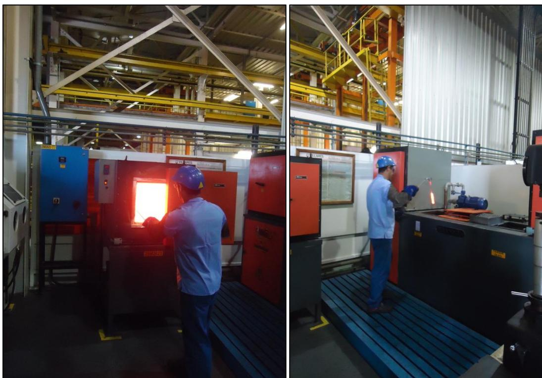
Figura 24 Tratamento térmico das barras de 50B35.
