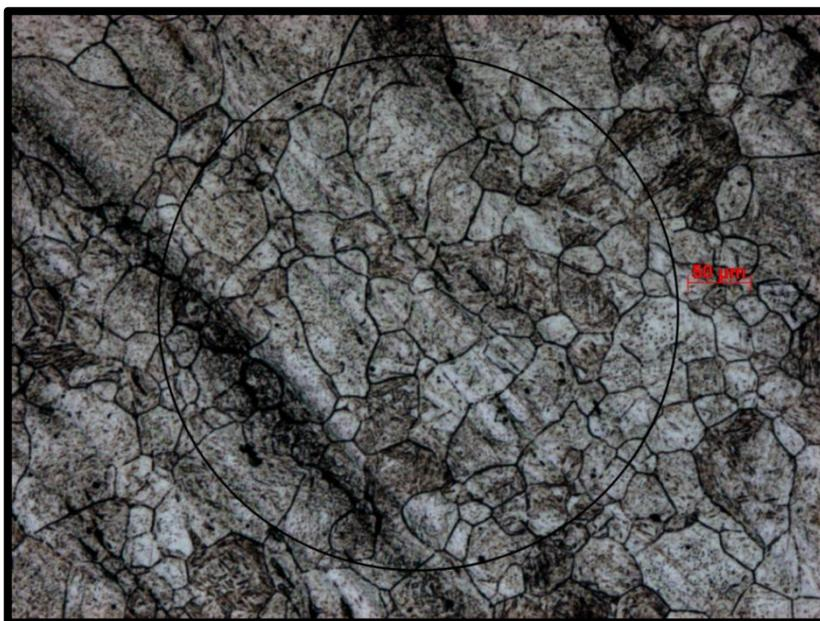
Figura 28 Micrografia da amostra tratada com 10 minutos. Aumento de 100x.
