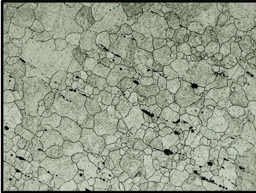
Figura 38 Micrografia da amostra tratada com 840 minutos. Aumento de 100x.
