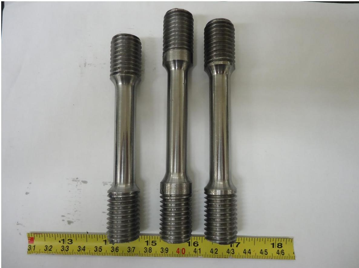
Figura 25 Corpos de prova de tração.
