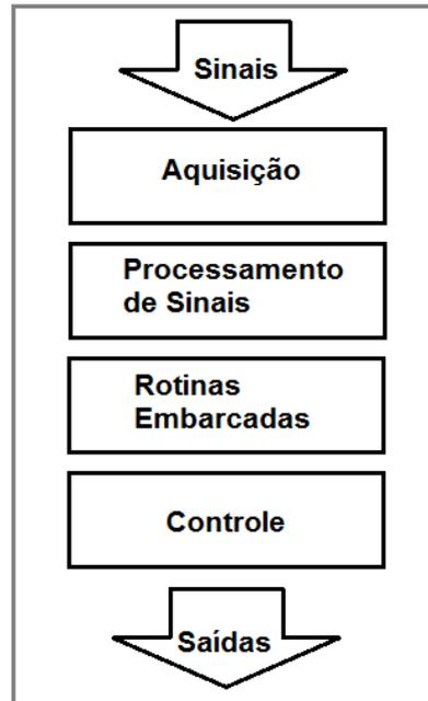
Figura 2.14 Processo simplificado de operação de um sistema embarcado.
