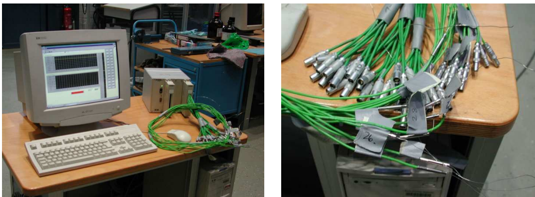
Figura 3.4. Aquisição de temperatura por meio do uso de termopares Tipo-K. Os termopares foram posicionados tanto na chapa soldada como no backing (fonte: GKSS)
