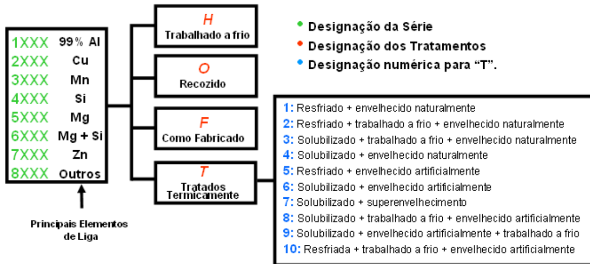
Figura 2.1. Nomenclatura das ligas de alumínio e tratamentos mecânicos e térmicos [3]
