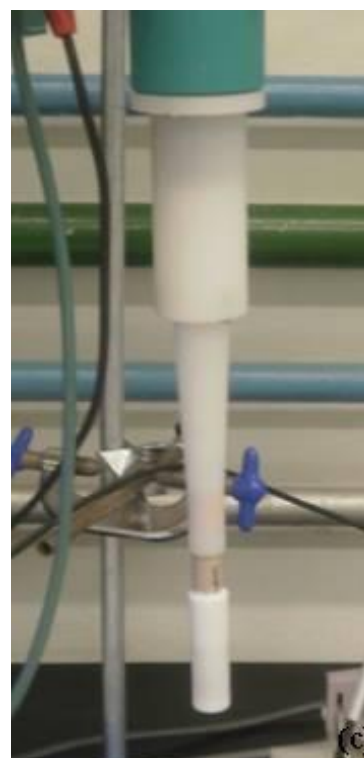
Figura 3.2 – (a) Representação esquemática do sistema experimental utilizado para a síntese eletroquímica sobre EDR: 1) computador; 2) potenciostato; 3) célula eletroquímica; 4) banho termostático; (b) foto do sistema experimental e (c) foto do eletrodo de disco rotatório.
