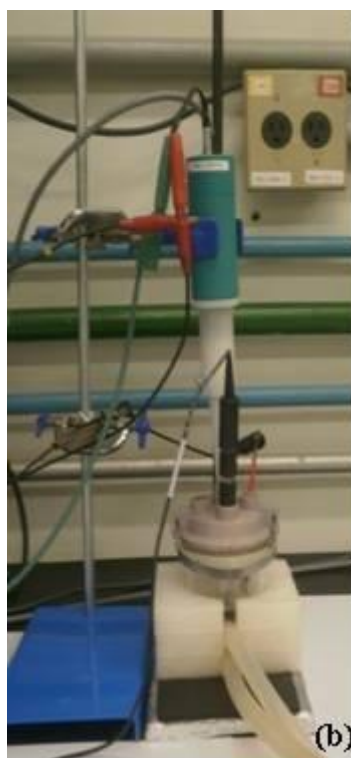
Figura 3.2 – (a) Representação esquemática do sistema experimental utilizado para a síntese eletroquímica sobre EDR: 1) computador; 2) potenciostato; 3) célula eletroquímica; 4) banho termostático; (b) foto do sistema experimental e (c) foto do eletrodo de disco rotatório.
