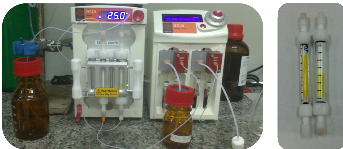
FIGURA 22. Equipamento de fluxo da Syrris (Asia) com reatores de leito fixo e os reatores (colunas) da Syrris (Asia) utilizados na síntese de meso -tetrafenilporfirina (TPP).
