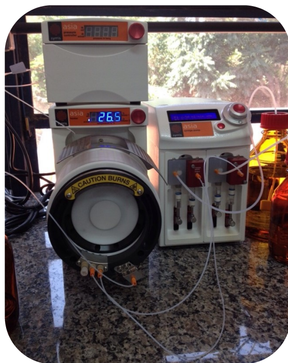
FIGURA 17. Equipamento de fluxo da Syrris (Asia) com reator tubular e sistema de bombas seringas utilizado nas sínteses de porfirinas.
