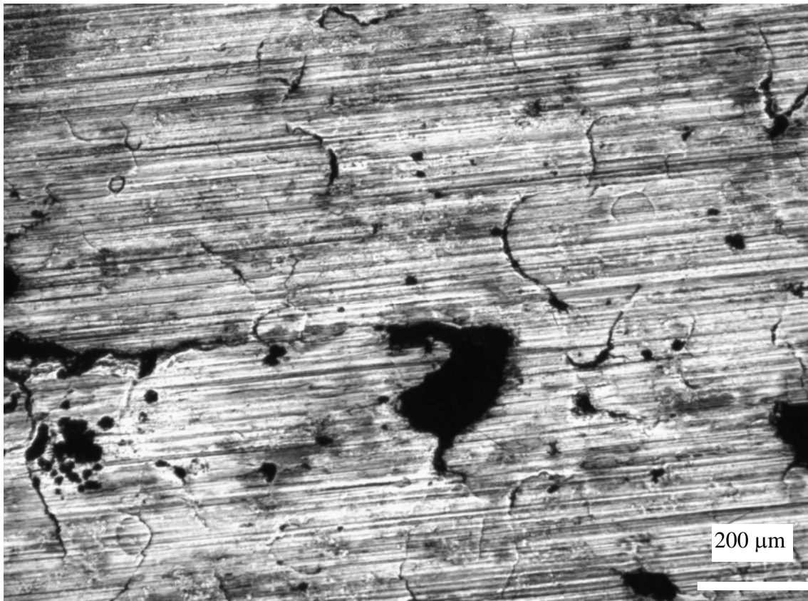
Figura .4.18 Trincas e porosidades em superfície retificada de CP da CS1. MO, aumento original 50x.
