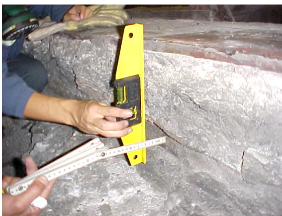
Figura 4.2 Desgaste do bloco lateral acima de 30mm.
