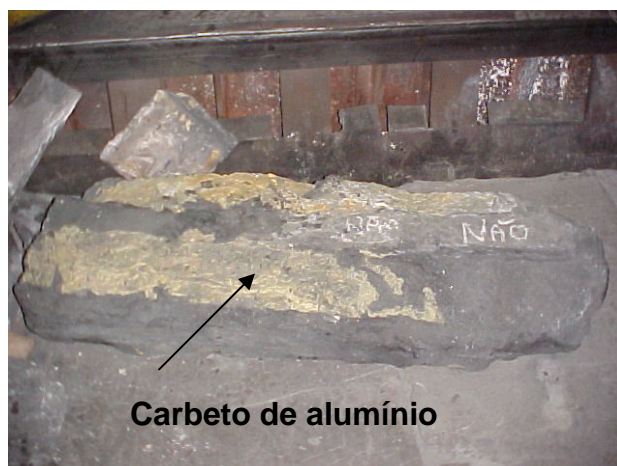
Figura 4.8 Laminação do bloco catódico ocasionada pela infiltração de metal em seu interior e formação do carbeto de alumínio.
