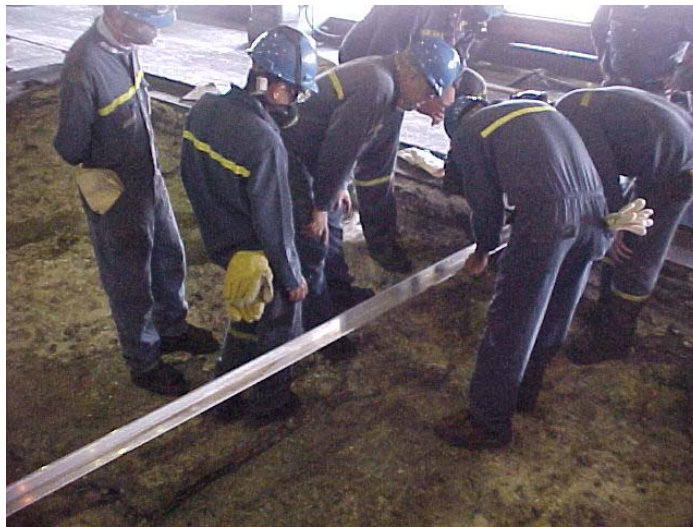
Figura 3.2 Medida de cavidade real do catodo em uma cuba desligada.
