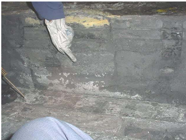
Figura 4.26 Traços de alumínio na lateral e superfície do bloco catódico #4.
