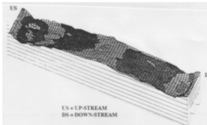
Figura 4.19 Desgaste dos blocos catódicos em formato de W [3]
