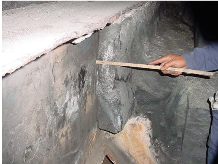
Figura 4.25 Espessura remanescente do bloco lateral de carbono (10cm).
