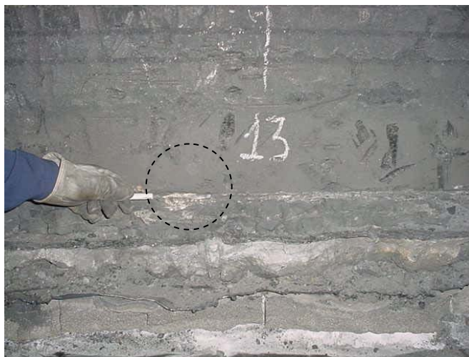
Figura 4.23 Traços de penetração de metal abaixo do bloco catódico
