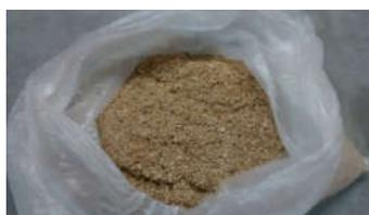
FIGURA 5.1 - Serragem triturada e peneirada em 0,2 mm.
