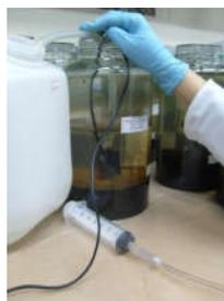
FIGURA 5.11 - Desmontagem dos microcosmos com auxílio de uma bomba de imersão e uma seringa plástica de 60 mL.
