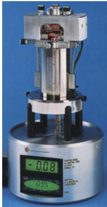
Figura 3.1 Microscópio de força atômica MultiMode™ SPM da Digital Instruments.
