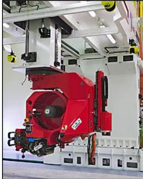
Figura 6 – Máquina de Laminação Automática da SAAB [15].
