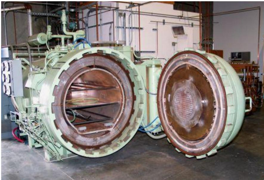
Figura 9 – Autoclave da Aerospace Composite Products, fabricante de peças em compósitos [21].
