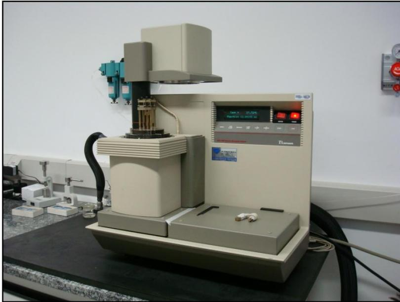
Figura 28 – Equipamento DMA 2980 da TA Instruments.
