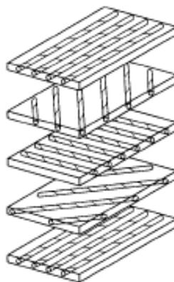
Figura 8 – Vista explodida de um laminado com diferentes orientações das fibras em cada camada [6].
