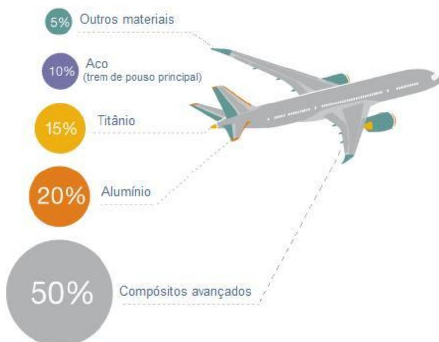
Figura 1 – Distribuição de porcentagem em peso dos materiais utilizados no avião Dreamliner 787 da Boeing, um exemplo de aplicações de materiais compósitos na indústria aeronáutica[2].
