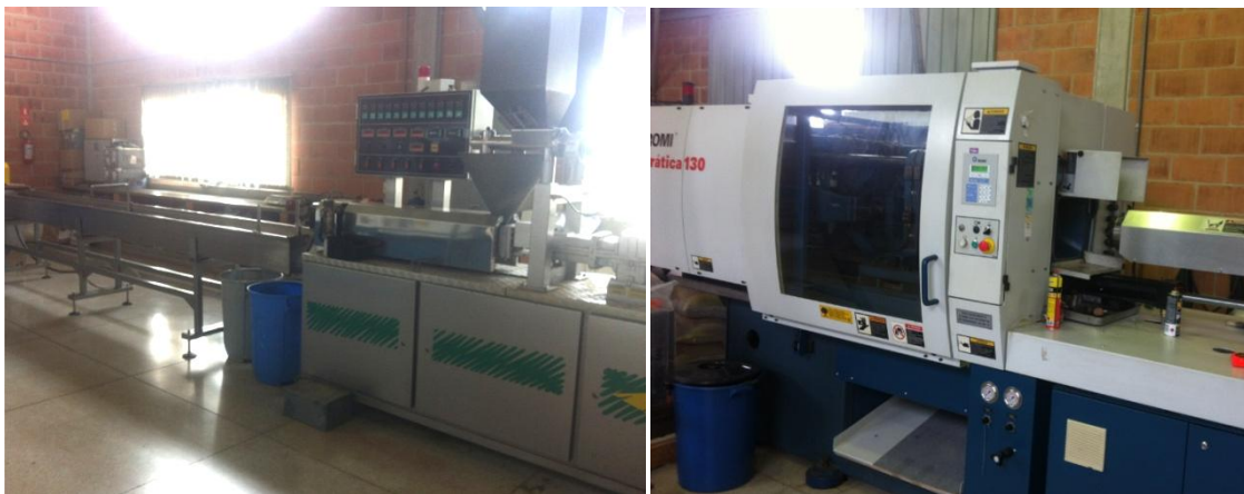
Figura 18 Extrusora IMACOM, Modelo DRC 30:40 IF à esquerda e injetora ROMI PRÁTICA 130 à direita.
