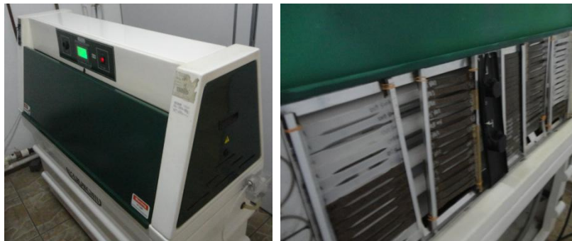
Figura 21 Equipamento EQUILAM Modelo: EQUV/Spray/Controle Automático de Irradiação à esquerda e os corpos-de-prova preparados para o ensaio de intemperismo UVB à direita.
