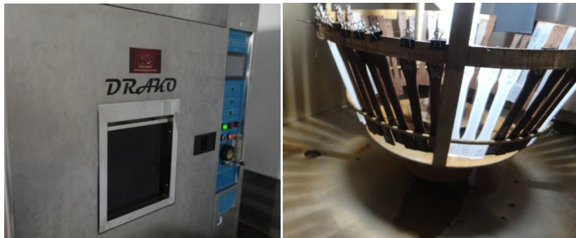
Figura 20 Equipamento JQ-100X à esquerda e os corpos-de-prova durante o ensaio de intemperismo arco xenônio à direita.
