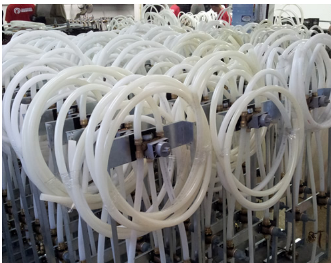
Figura 25: Kits hidráulicos com o uso de PEX
