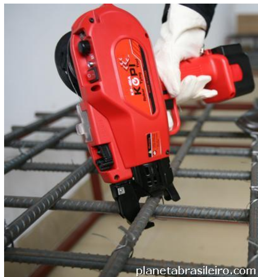
FIGURA 31 – Máquina de amarrar armaduras
