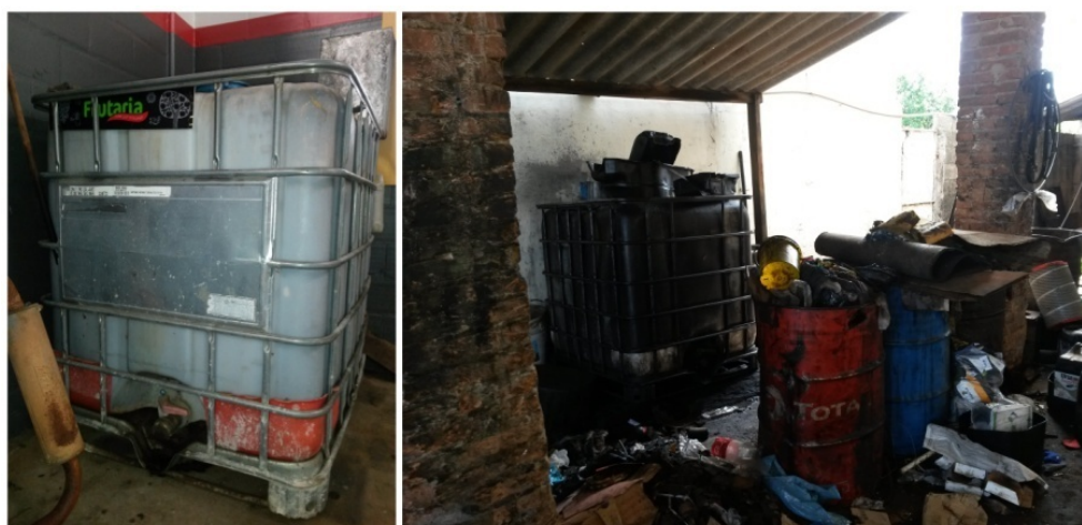
Figura 42 - Armazenamento de óleos lubrificantes em “containers” – à direita em centro-automotivo – à esquerda em oficina mecânica de veículos de maior porte (ônibus e caminhões)
